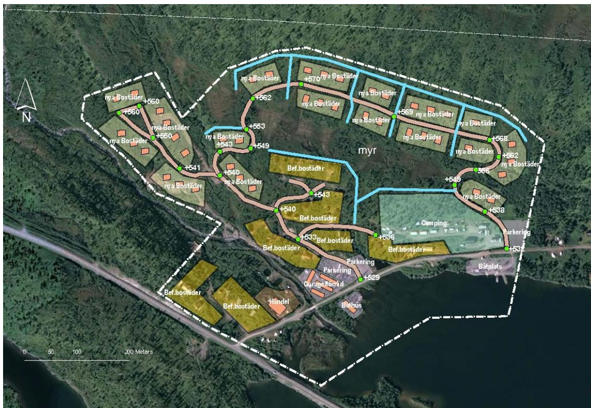
Bild hämtad från planprogram för Kåtavikens fritidsby. Den stora myren magasineras dagvattnet i området och fördröjer avrinningen. Viss dikning kan behövas norr om planerad ny bebyggelse för att leda dagvattnet förbi tomtplatserna. Blå linjer illustrerar öppna växtbäddade diken med trummor under väg, vägarna illustreras med ljusbrun linje. Kartan visar endast en principlösning hur ett system för avledning av dagvatten kan utföras.
