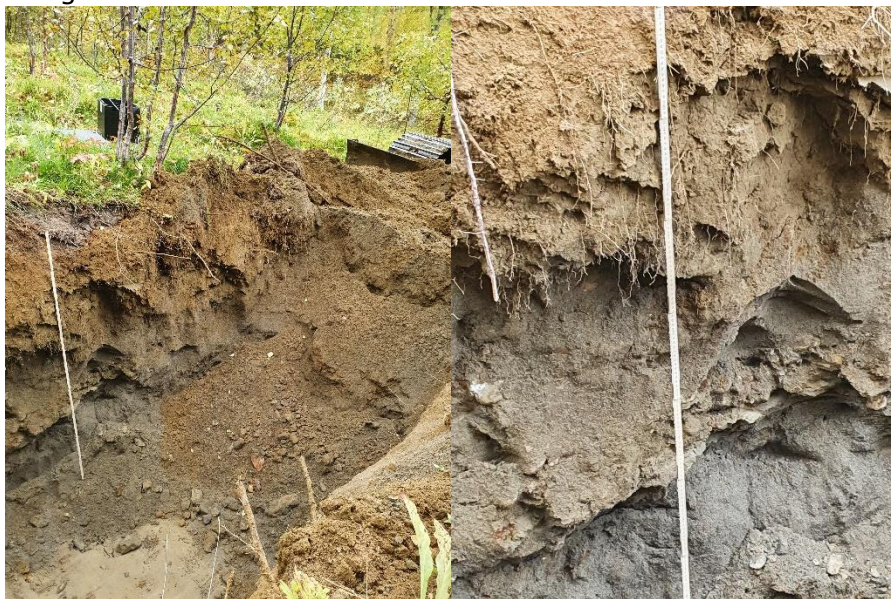
Figur 11. Foto tagit i provgrop 4, jorden bestod av sand ovan silt.
