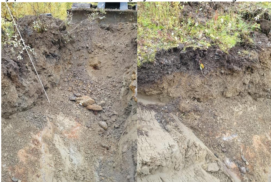
Figur 9. Foto tagit i provgrop 2, jorden bestod av sandig silt, en del större stenar i det ytliga lagret 0-1 m.
