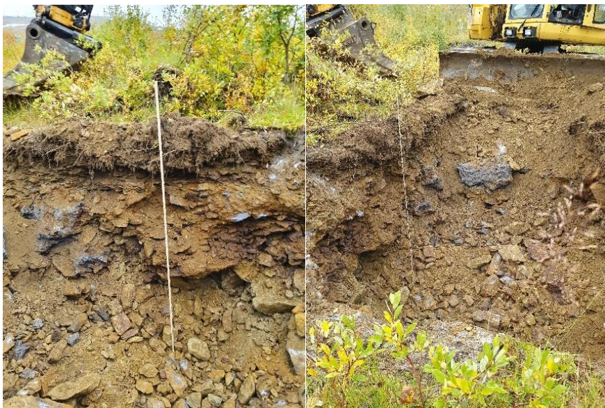
Figur 8. Foto tagit i provgrop 1, jorden bestod av en sandig silt med inslag av fyllningsmassor i de översta 0-1 m.
