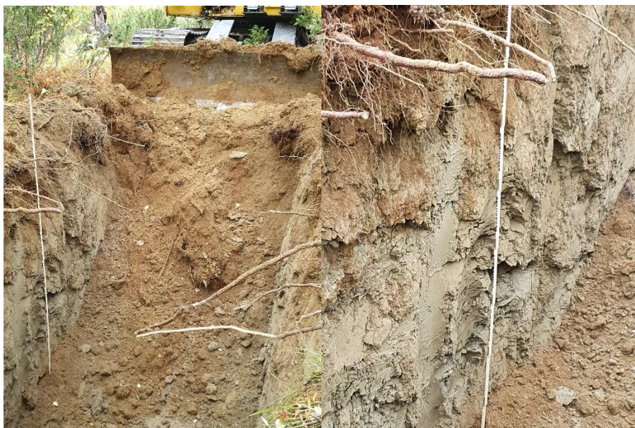
Figur 10. Foto tagit i provgrop 3, jorden består främst av sandig silt-silt.
