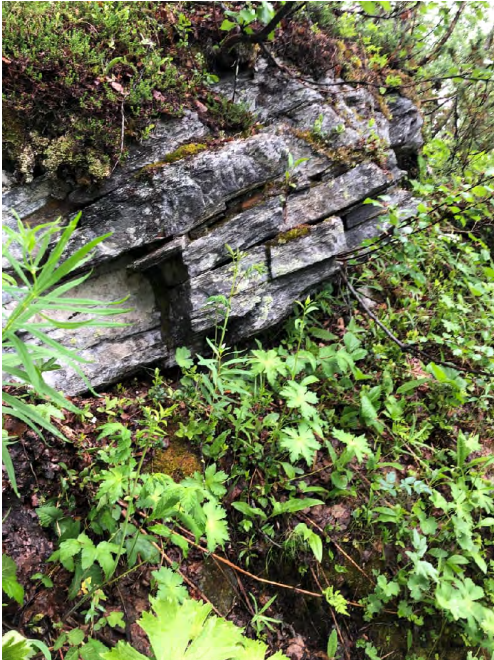
Figur 1. Foto 1. Framstickande berg. Sprickriktning; strykning nordnordväst och stupning 25 grader. C/C-sprickavstånd ca 10-30 cm.
