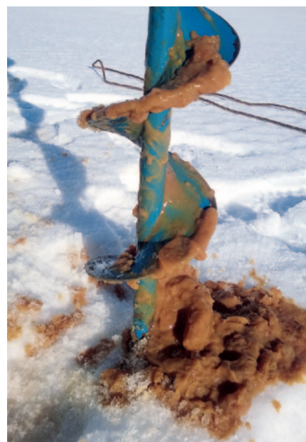
Ett borrprov från den överfulla sedimentationsbassängen.
