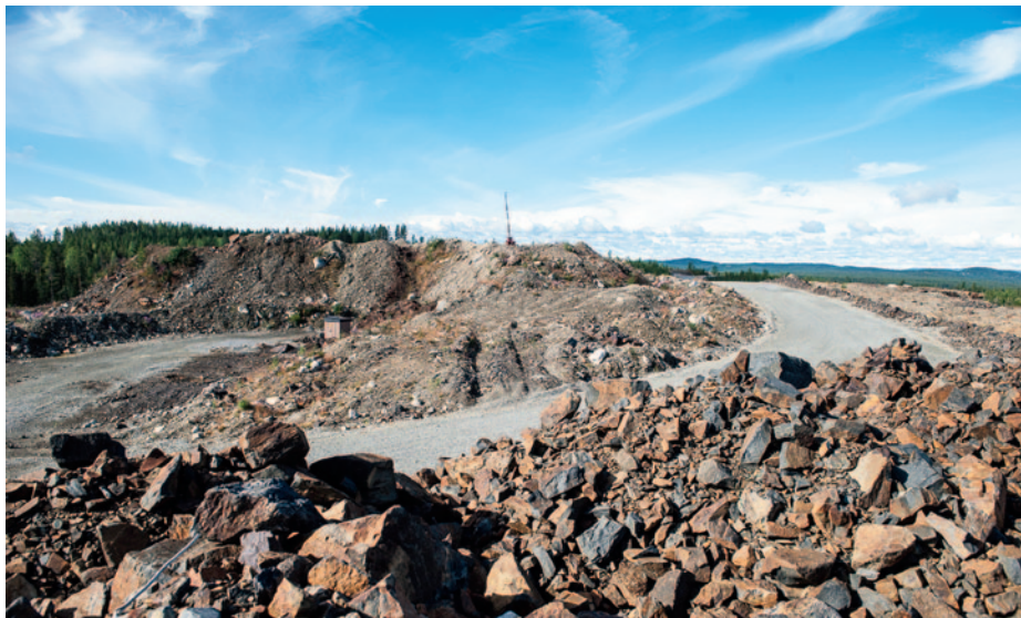
Förutom 150 000 ton malm bröts även 720 000 ton gråberg som lagts upp på området.
